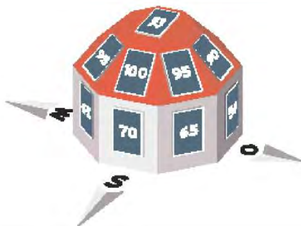
Уменьшение выхода энергии из-за отклонения от оптимального направления на юг и угла наклона
